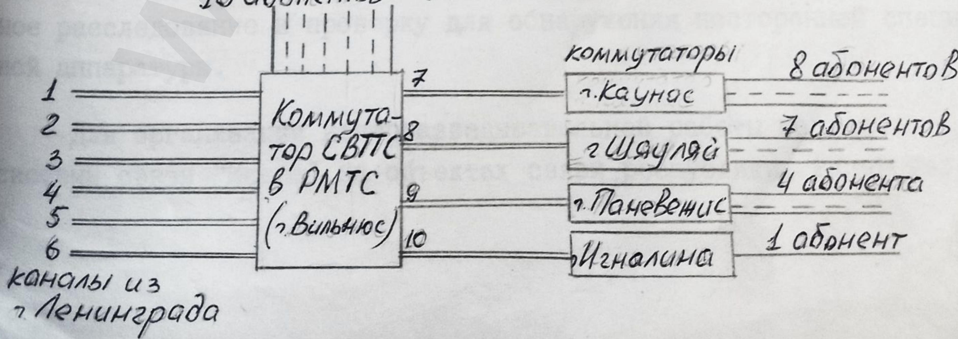
Связь по 10 каналам между коммутаторами СВТТС осуществляется с использованием аппаратуры уплотнения.
